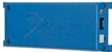
Riadiaca jednotka umiestnená pod prístrojovou doskou
